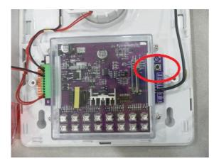
In questo modo la sirena entra nella modalità "programmazione" e se l'operazione è stata eseguita correttamente rimangono accesi i primi 2 leds a sinistra come in figura:
