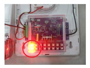
Accendere la centrale di allarme ST6 collegando l'alimentatore alla corrente elettrica e premere il pulsante code sul trasmettitore e tenerlo premuto per 5 secondi, quindi rilasciarlo:
