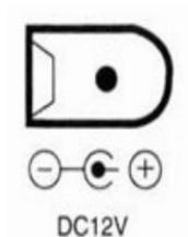
L'apparecchio accetta alimentatori a 12v 1000mA stabilizzati
