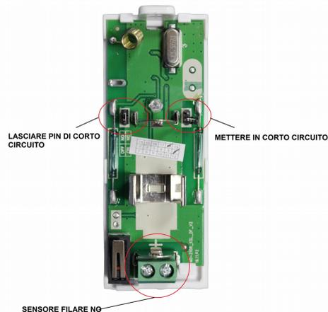
FUNZIONAMENTO COME TRASMETTITORE PER SENSORI FILARI NC
