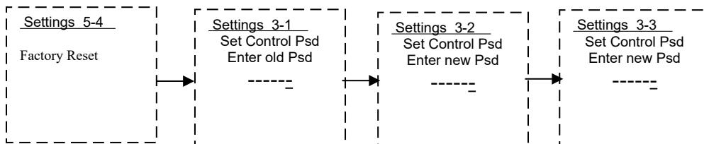
Dopo essere entrato in “System Set”, scegli “Set Control Psd”, poi premi su [ ], inserisci la password da cambiare. Per cambiare la password inserisci prima quella vecchia, poi premi su [ ] per inserire la nuova password.
