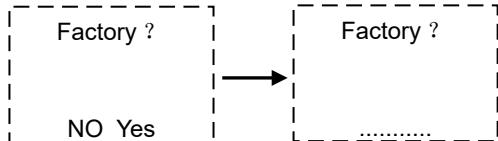
Dopo aver effettuato il reset, tutte le associazioni saranno eliminate, così come i numeri di telefono, le registrazioni dell'allarme e le operazioni da telecomando, tutte le password torneranno allo stato originale.
