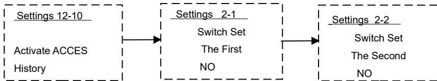
Il sistema supporta due canali di trasmissione in output, quando selezioni “Yes”, la trasmissione corrispondente funzionerà tramite collegamento esterno. Scegli “No”: solo tramite SMS o telefono remoto per chiudere o disconnettere. (Si prega di fare riferimento al capitolo del telecomando per maggiori dettagli).
