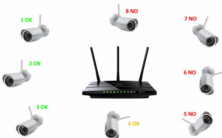
Le antenne delle IP Cam 1, 2 e 3 sono orientate in modo corretto.
