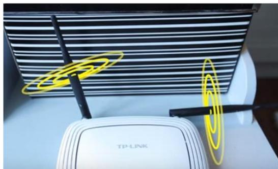
**NOTA:** per una buona copertura è opportuno installare il router in posizione centrale rispetto all'area da coprire, e se necessario prevedere l'installazione di ulteriori Access Points o Ripetitori.
