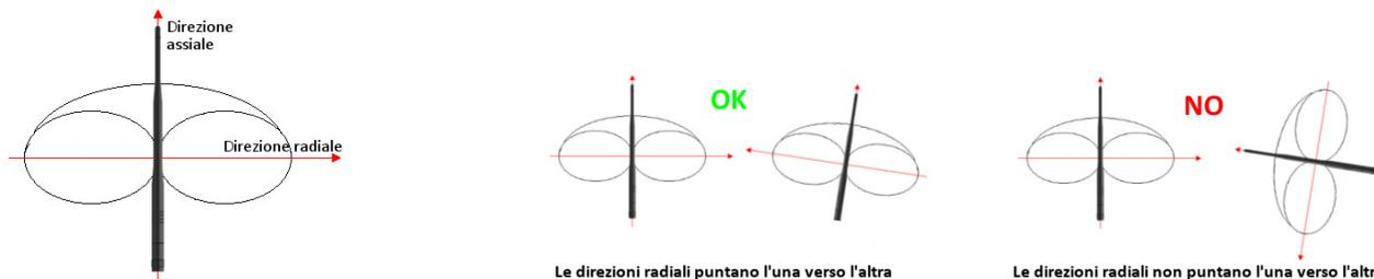
Ne segue che per orientare in modo corretto i dispositivi occorre fare in modo che la direzione radiale delle antenne delle IP Cam punti in direzione del router.
