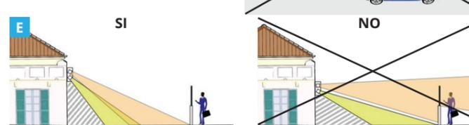
Non orientare le testine in modo da avere i fasci paralleli al terreno. I fasci dovrebbero sempre terminare contro una superficie (muro, terreno) in modo che l'area di rilevazione sia confinata. Non puntare verso uno spazio aperto.
