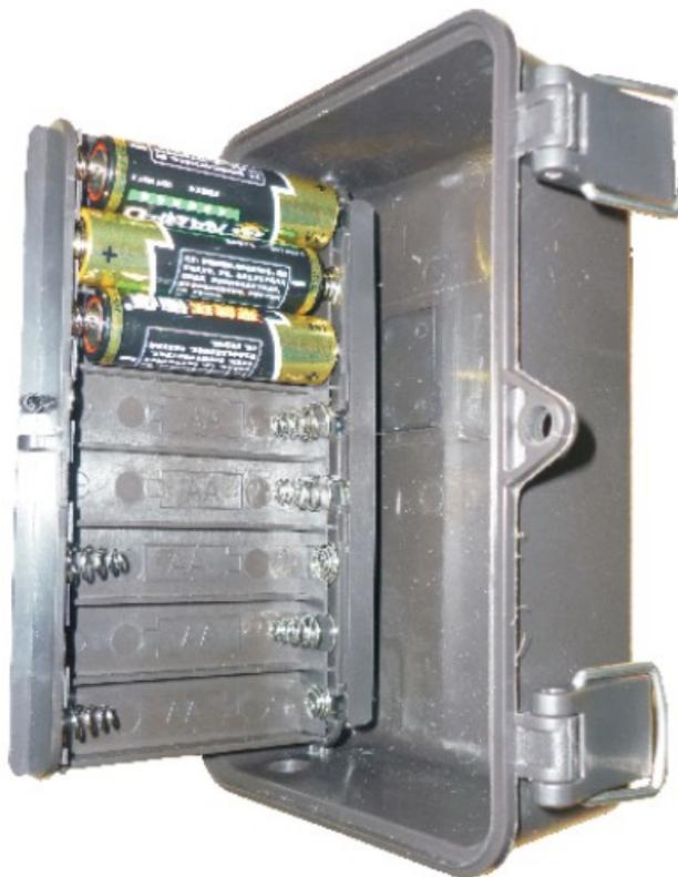
Si raccomanda l'utilizzo di otto nuove batterie al litio AA o alcaline AA oppure batterie ricaricabili NiMh. Utilizzando un alimentatore esterno ( opzionale , non fornito ), è possibile collegare una fonte di alimentazione CC 6V al connettore "DC IN".
