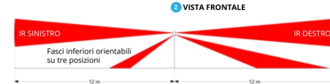
Ogni lato del Mosquito dispone di una coppia di testine di rilevazione ad infrarossi (fig. C-2): testina superiore (rilevazione orizzontale o lontana) e testina inferiore (rilevazione verso terra o vicina). Quando il sensore lavora in modo NORMALE, l'allarme verrà generato solo se entrambe le testine di ciascun lato rilevano un'intrusione (AND).
