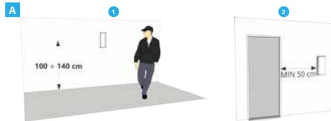
L'altezza di installazione del sensore deve essere compresa tra 100 cm e 140 cm (fig. A-1). È consigliabile installare il sensore a non meno di 50 cm dal varco più vicino (fig. A-2).
