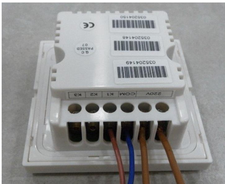
Realizzando i collegamenti in questo modo il dispositivo già funziona come un normale interruttore a sfioramento,quando la spia è accesa l'utilizzatore è spento,quando è spenta la spia l'utilizzatore è acceso.
