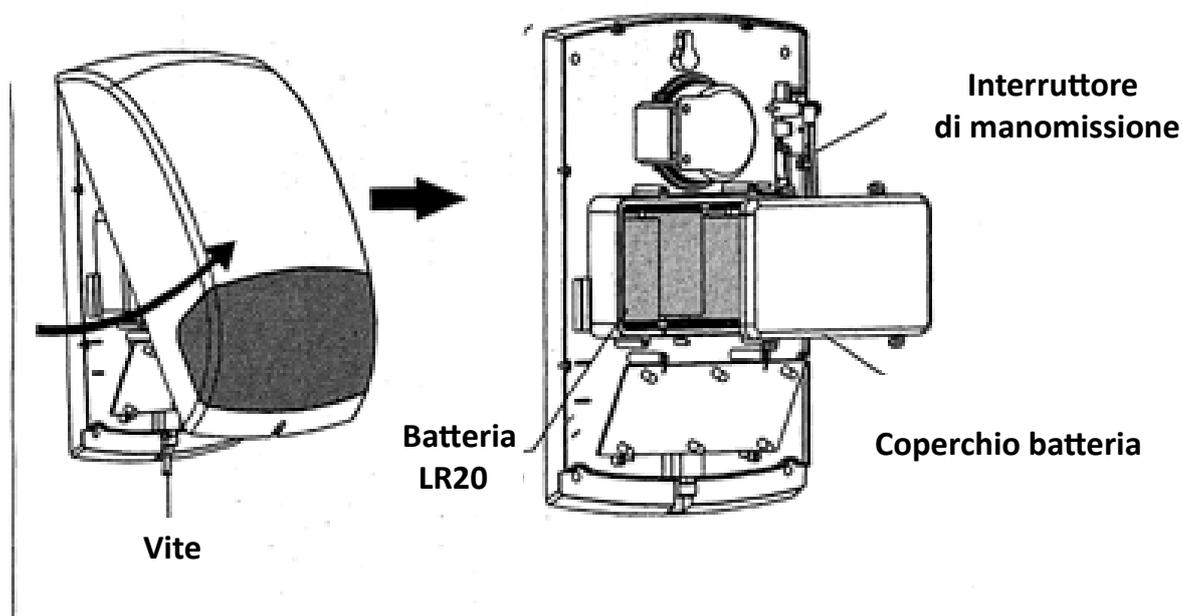
Quando il pannello riceve il segnale di “batteria scarica” dal dispositivo, siete pregati di sostituire la batteria utilizzando le seguenti le istruzioni:
