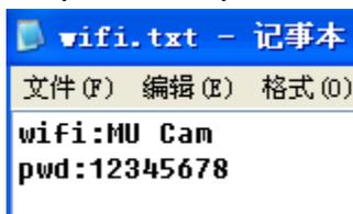
modificare il dispositivo MU Cam nel segnale del vostro WiFi, inserire 12345678 come password. Salvare e inserire la scheda TF nella telecamera, questa completerà automaticamente la configurazione, non sarà più necessario eseguire alcuna operazione. Quando le luci rosse della telecamera sono accese, significa che la telecamera è collegata alla rete.
