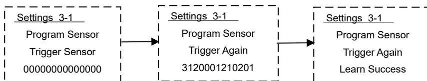
Premi su [🔊] per eliminare l'informazione originale, poi inserisci 2 cifre da 01~30, premi su [OK] entra nel menu e scegli "Activate Sensor", attiva il rilevatore una volta. Un secondo dopo, il sistema chiederà "Trigger Again", adesso innesca il rilevatore di nuovo, poi l'host mostrerà "Learn Success", significa che è avvenuto correttamente. Un secondo dopo ritornerà automaticamente alla posizione precedente, ovvero alla scelta del codice del rilevatore.
