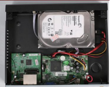
Sostenendo e tenendo in posizione il disco rigido, capovolgere il DVR/NVR, e fissare il disco rigido con 4 viti. Infine rimontare la cover e riavvitare le viti di fissaggio della stessa.
