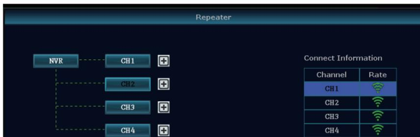
Nel sottomenu Repeater, fare click sul tasto + a destra della telecamera IP da impostare come ripetitore, quindi selezionare il canale relativo alla telecamera IP esterna, che si collegherà all’NVR attraverso il ripetitore.
