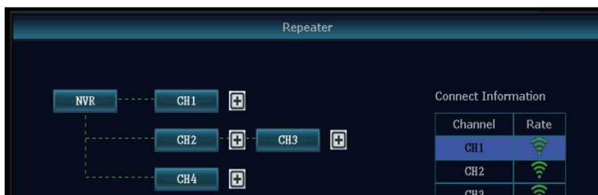
**NOTA:** nel caso in cui la telecamera esterna si trovi fuori dall’area di copertura del segnale wifi, l’utente può rimuoverla e avvicinarla temporaneamente all’NVR, quindi procedere con la configurazione della funzione di ripetizione del segnale, ed infine installare nuovamente la telecamera correttamente configurata nel luogo di destinazione.
