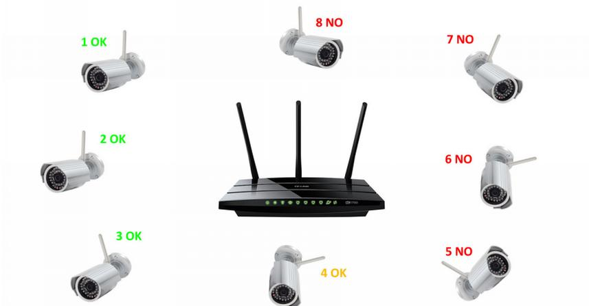
Le antenne delle IP Cam 1, 2 e 3 sono orientate in modo corretto.
