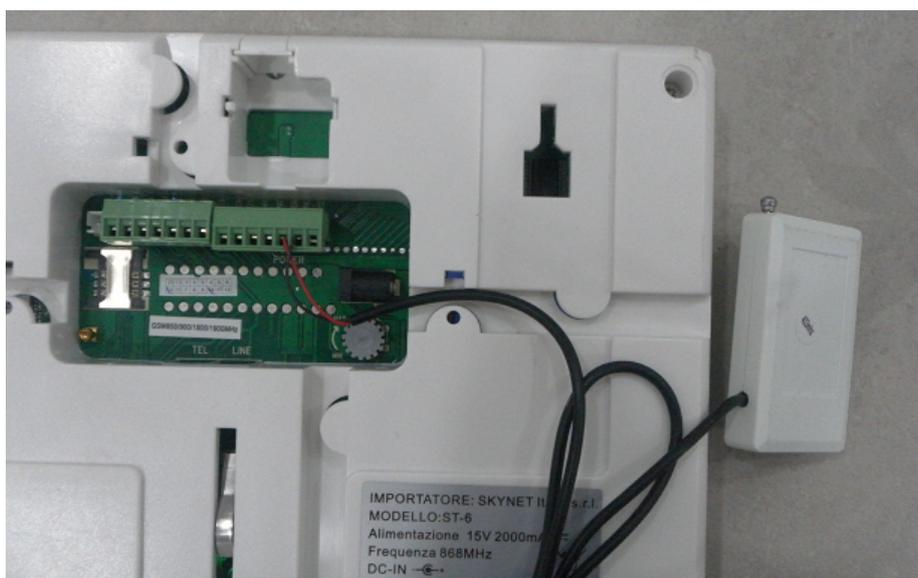
Fornire alimentazione alla sirena esterna,prelevando l'alimentazione direttamente dalla centrale di allarme dai piedini GND(-) +12(+) oppure usando un alimentatore da 12 volt che porta già l'attacco pronto per essere collegato alla sirena ad esempio io nostri modelli da 500 mA o 1500 mA.
