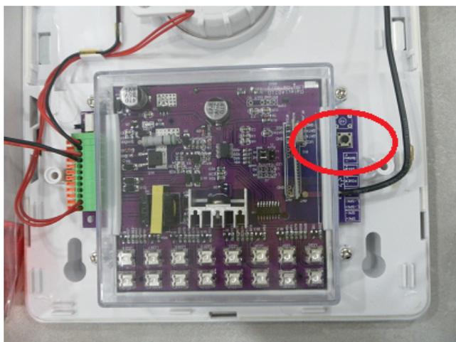
In questo modo la sirena entra nella modalità "programmazione" e se l'operazione è stata eseguita correttamente rimangono accesi i primi 2 leds a sinistra come in figura:
