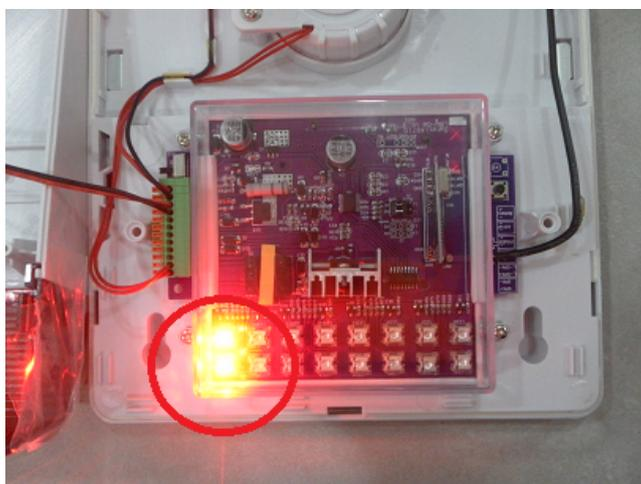
Accendere la centrale di allarme ST6 collegando l'alimentatore alla corrente elettrica e premere il pulsante code sul trasmettitore e tenerlo premuto per 5 secondi, quindi rilasciarlo:
